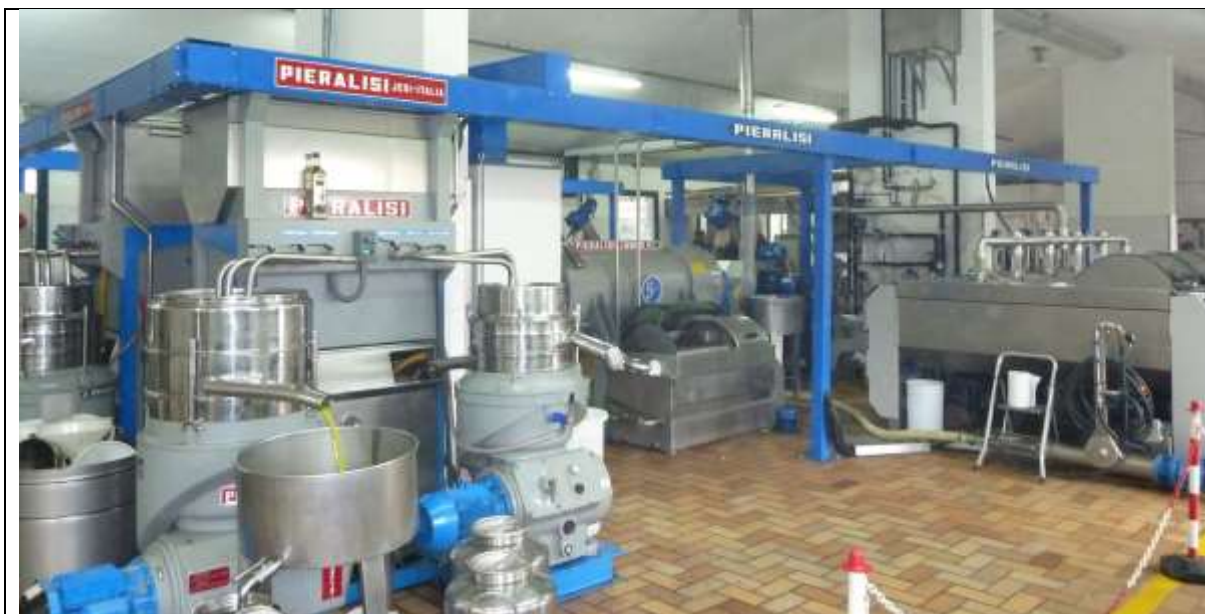
Impianti di estrazione dell'olio detti "ciclo continuo" dell'Az Peralisi ( lisciocomelolio.blogspot.com )
